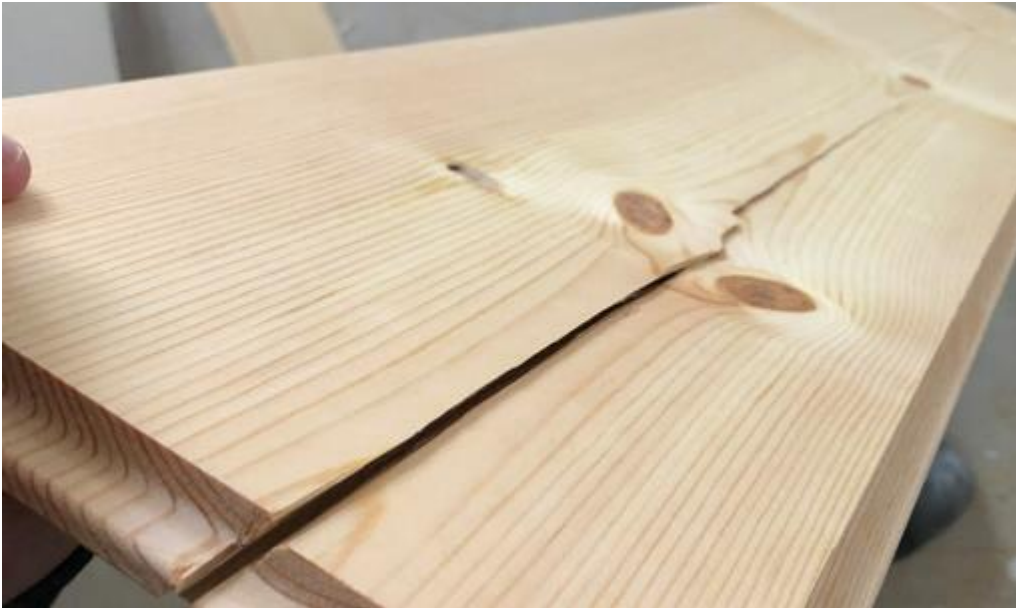
Brædder som er revnet et stykke, men hvor resten af brættet er ok
