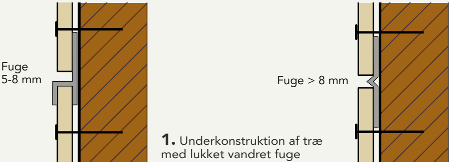
2. Underkonstruktion af træ med halvlukket vandret fuge
