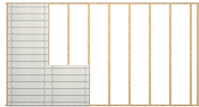
Montage af Therm25™ gulvarmeelementer i underkonstruktionen (skruer 40 mm eller klammer 50 mm).
