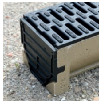
Før montering af endegavl på Euroline, bortskæres Tap B og Tap X i både højre og venstre side.
