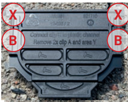
Før montering af endegavl på Euroline, bortskæres Tap B og Tap X i både højre og venstre side.
