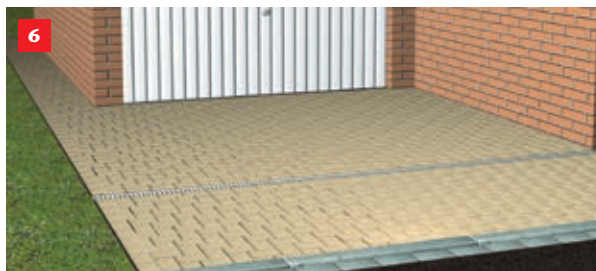
Færdigmonter linjedræn. Må først ibrugtages og overkøres når betonen er gennemhærdet.
