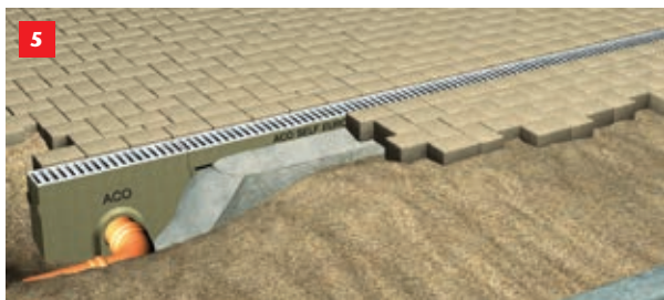
Genetablér belægningssten. Bemærk overkant af belægnings- sten skal være 3-5 mm over ristens overkant.
