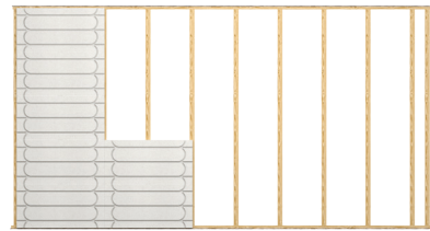
Montering af Therm25™ elementer i understruktionen (skruer 40 mm eller klamrer 50 mm).
