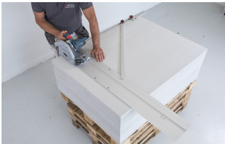
1. Angle. Design vinkelsættet vises her til brug sammen med føringssav. Føringsskinnen passer til alle rundsawe.
