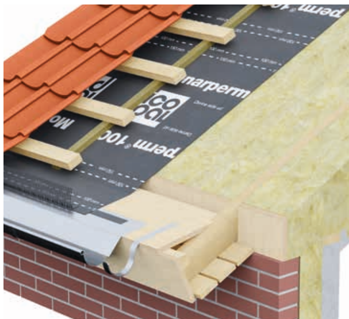
TAGFOD MED UDHÆNG, UVENTILERET
