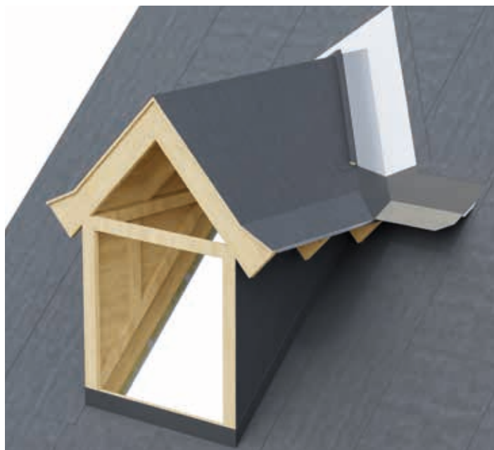
Skotrenden tættes langs kanterne med en klæbet eller påsvejet tagpapstrimmel. På kvistsiden monteres en trykimprægneret afstandsliste under tagpapstrimlingen.
