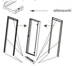
Fastspænd hængsler og slutblik. Monter dækpropper og dør.
