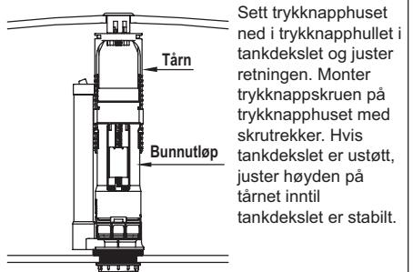
Sett trykknaphuset ned i trykknaphullet i tankdekslet og juster retningen. Monter trykknappskruen på trykknaphuset med skrutrekker. Hvis tankdekslet er ustøtt, juster høyden på tåret inntil tankdekslet er stabilt.
