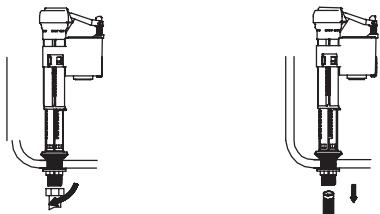
Steng vanntiførselen, skru av mutteren for vanntiførselsslangen.
