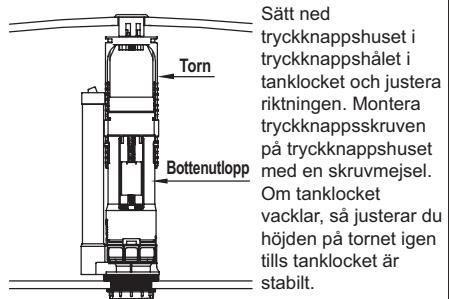
Sätt ned tryckknappshuset i tanklocket och justera riktningen. Montera tryckknappsskruven på tryckknappshuset med en skruvmejsel. Om tanklocket vacklar, så justerar du höjden på tornet igen tills tanklocket är stabilt.
