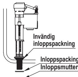
3. Justering av vattennivån: Ta ut låset och justera det ytter flottörhuset så att det är till vänster. Sätt i låset och vrid justeringsskruven för att få den i ett lodrätt läge.
