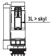
3. Justering af vand niveau: Få låsen ud, og juster det ydre svømmehus så det er til venstre. Sæt låsen i og drej justerings skruen for at få den i en lodret position.
