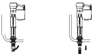
Sluk for vandtilførslen, afmonter møtrikken for vand tilførslen linjen.
